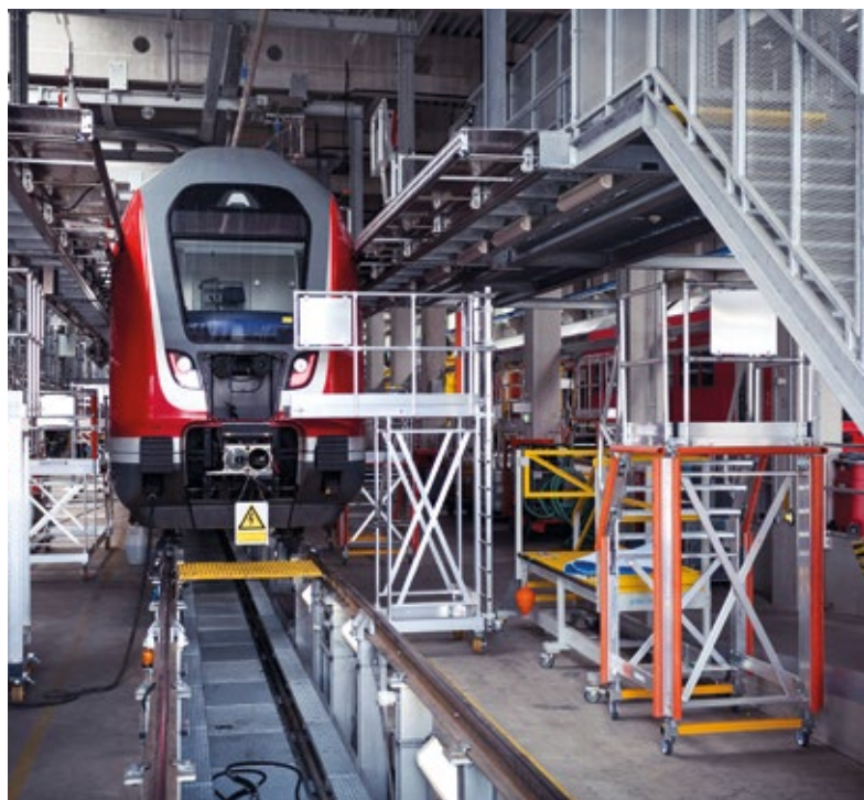
Praktisch abwasserfrei: Auf fünf Gleisen können Züge, im Fachjargon „Garnituren“ in die Halle fahren – dort werden sie gereinigt und instandgesetzt
