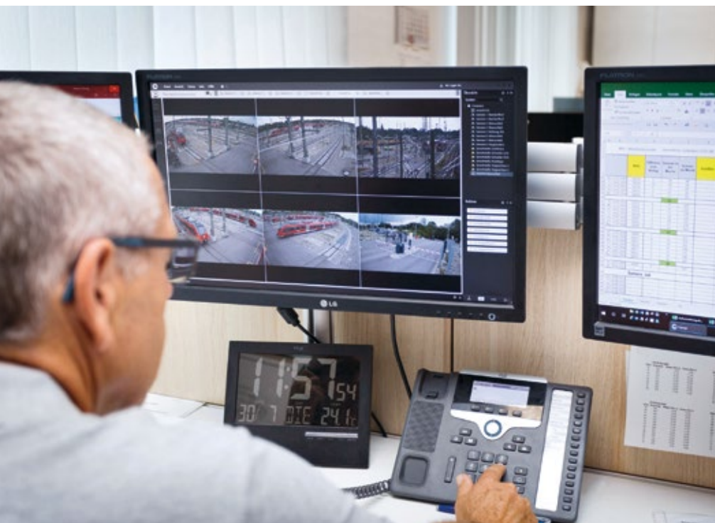
Die Videomanagementsoftware Cayuga von Qognify sorgt dafür, dass die Bilder verschiedener Außenkameras zusammenlaufen und über einen einzigen Arbeitsplatz verwaltet werden können
