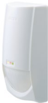
◀ Das CDX-DAM-Modell verfügt über eine dichte optische Konfiguration, durch die 82 individuelle Erkennungszone entstehen. Bei der digitalen Quad-Zonen-Logik, müssen vier oder mehr Zonen passiert werden, um einen Alarm auszulösen
