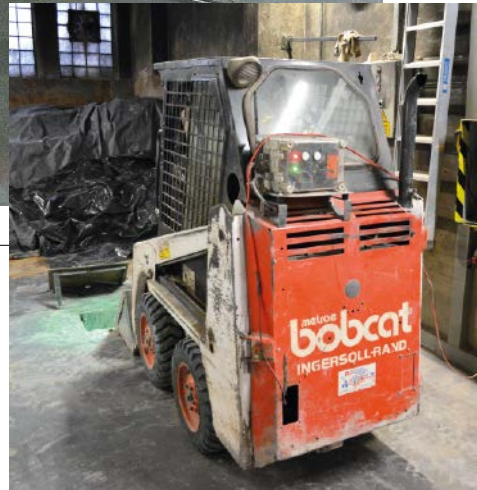
▲ Das Material wird mit einem kompakten Radlader durch den Massenabwurf in den Extruder für die Strangpressanlage befördert
