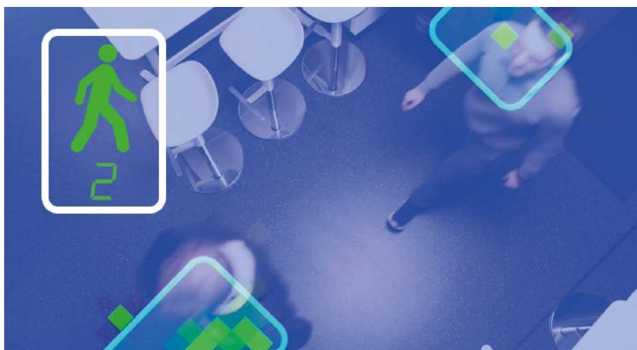
Der smarte IoT-Sensor zählt die eintretenden Personen in einem Raum (Durchgangszählung) sowie die Menschen, die sich in einem Raum aufhalten (Präsenzzählung) – und misst gleichzeitig die Luftqualität
