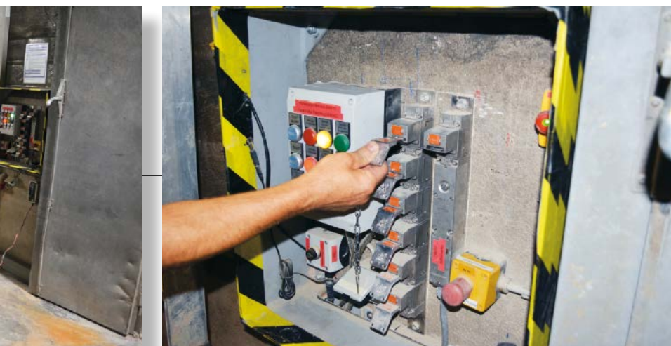
▲ Erst wenn alle Türen verriegelt sind, kann der Bediener den STS-Schlüssel mit dem Zündschlüssel entnehmen
