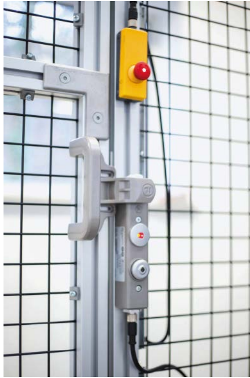
Die Sicherheitstürzuhaltung tGard am Schutzzaun wird direkt am Safety Simplifier angeschlossen
