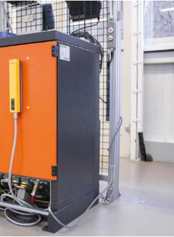
Der Safety Simplifier am Roboter-Schaltschrank empfängt wireless Signale und schaltet den Roboter sicher ab
