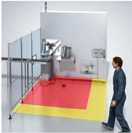
Die Überwachung des Arbeitsraumes des Roboters mittels SBot Speed-UR erfolgt durch ein Warnfeld (gelb) und ein Schutzfeld (rot). So werden die Betriebsbedingungen des Roboters automatisch an die Position von Personen in dessen Umfeld angepasst.
