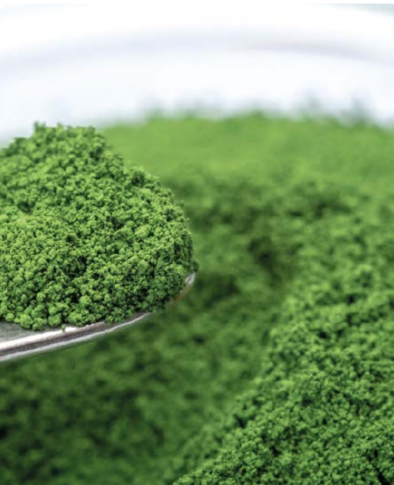
▲ Chromoxid-Pigmente gelten als besonders wetterfest und lichtbeständig. Sie werden zum Beispiel für die Lackierung der Kölner Brücken verwendet
