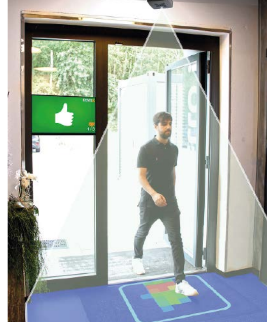
Mit dem Multisensor-TI ist es möglich, ein- und austretende Personen exakt zu registrieren und gleichzeitig die Luftqualität zu messen
