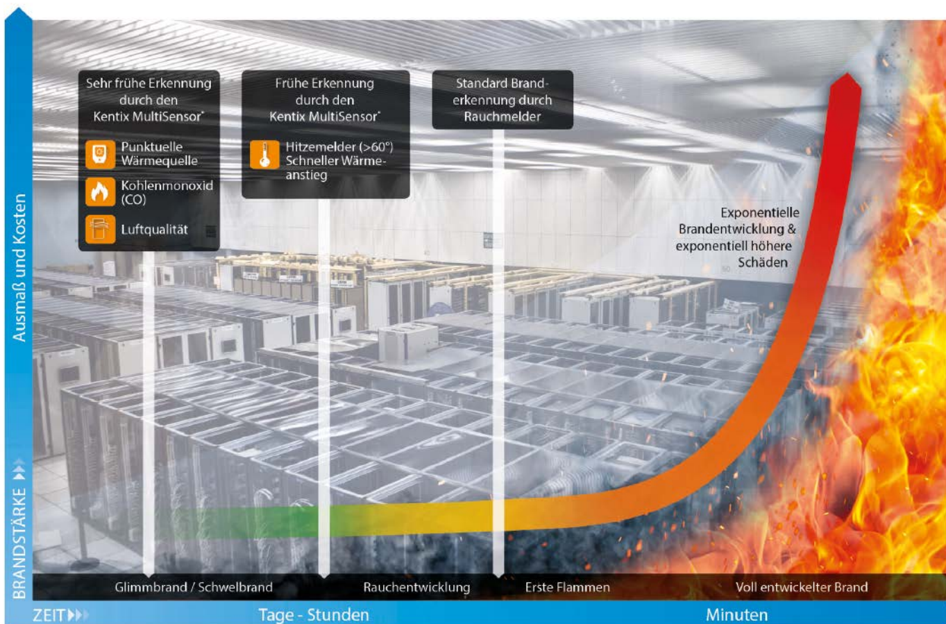
Der Multisensor-TI von Kentix kann bis zu 37 Parameter bzw. Gefahren messen. Damit lassen sich Brände erkennen, bevor sie entstehen
