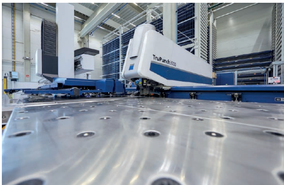
Abb. 2: Die Stahlelemente werden auf hochautomatisierten CNC-gesteuerten Laser- und Biegemaschinen produziert
