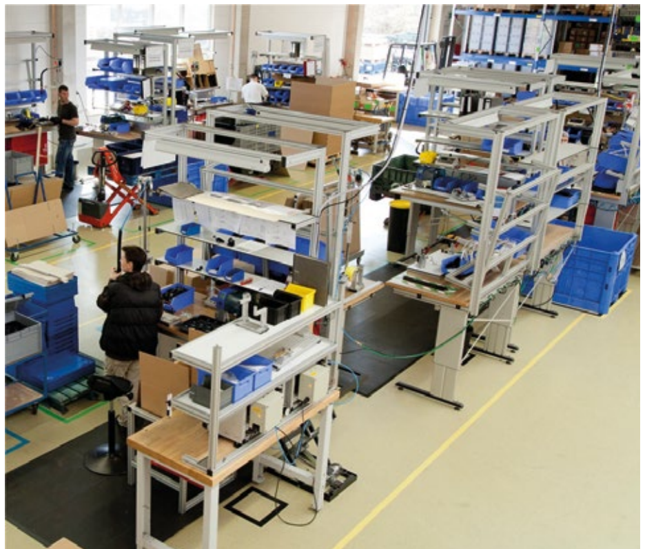
RK Easywork-Arbeitsplätze zeichnen sich durch optimal kombinierbare Arbeitsabläufe und ein Höchstmaß an Ergonomie aus. Bei einem Hersteller von Differenzdrucksensoren haben die elektrisch höhenverstellbaren Arbeitsplätze die Produktivität deutlich gesteigert
