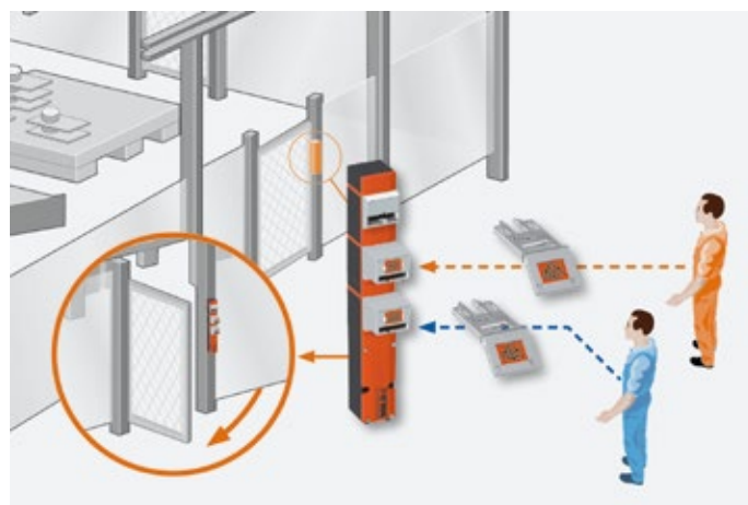
Ein Persönlicher Schlüssel schützt vor Einsperrung
