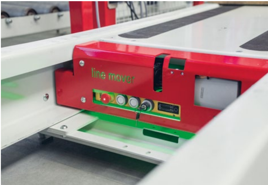
▲ In das Gehäuse des Line Movers integrierter Safety Simplifier (gelb)
