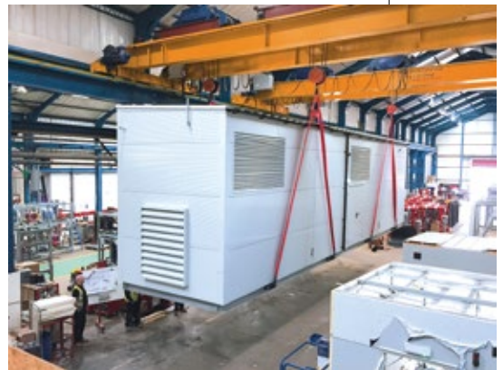
Die zwei Oxyreduct-Anlagen mussten vorinstalliert und per Schwerlasttransport befördert werden
