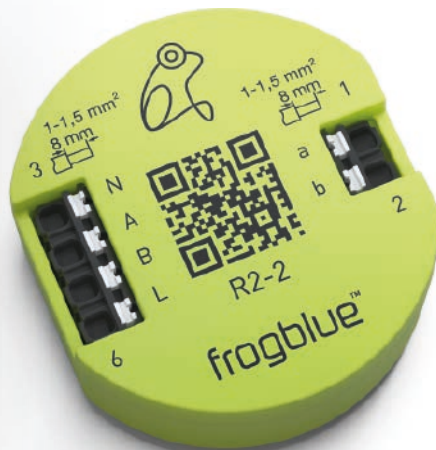
Das System basiert auf „Frogs“, die hinter dem Lichtschalter in der Unterputzdose verbaut werden und über Bluetooth LE miteinander kommunizieren
