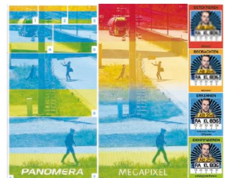
Die Sensoren decken unterschiedliche Bildbereiche mit unterschiedlichen Brennweiten ab. Dies ermöglicht selbst in der Aufzeichnung hochauflösende Zooms in jedem Teilbereich und gewährleistet die erforderliche Datenqualität für Videoanalyse-Anwendungen
