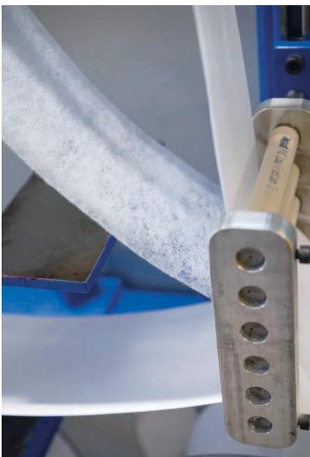
FFP-Masken von Dräger bestehen aus nichtgewebten Materialien, vor allem aus dem sogenannten „Meltblown-Spinnvlies“
