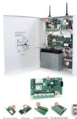
weiterung des verfügbaren Speicherplatzes, abgesehen von der direkten Aufnahme (ohne Kommunikationsbus zur maximalen Steigerung der Übertragungsgeschwindigkeit von Informationen und Daten) sowohl des 3G-Moduls (bald auch 4G-LTE) als auch – wo erforderlich – des PSTN-Moduls. Damit ist das Senden von Sprachnachrichten, E-Mails, SMS, Push-Benachrichtigungen, Contact ID und dem Protokoll SIA DC-09, Level III, an die Überwachungszentralen möglich.
