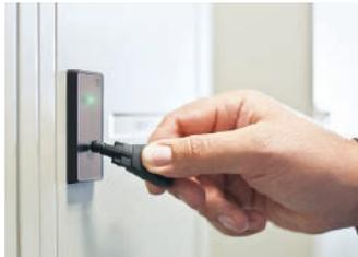
sende CR123A-Batterie. Das Verbindungskabel befindet sich jetzt zwischen Lese- und Schlosseinheit und ist daher vor Beschädigung oder Vandalismus geschützt. Das Schloss ist mit feststehendem und alternativ mit gefedertem Riegel erhältlich.
