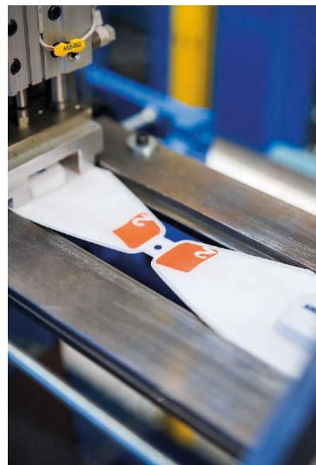
Das Ausatemventil wird auf die Dräger X-plore 1900 der Schutzklasse FFP2 gestanzt
