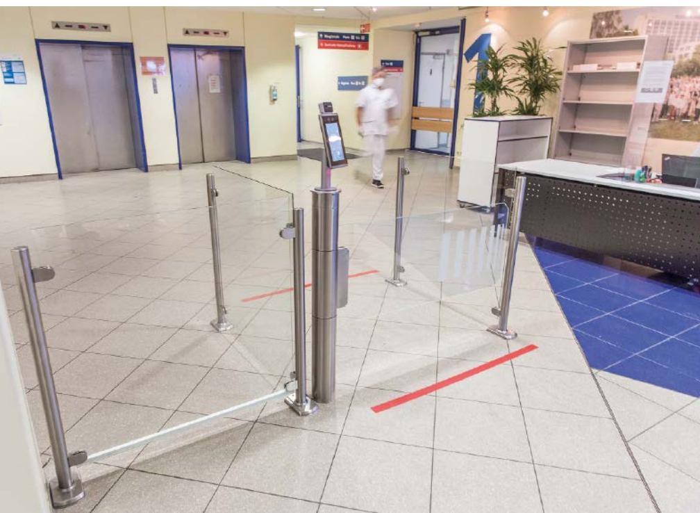
Ist die Körpertemperatur im Normalbereich und trägt der Eintretende einen Mund-Nasen-Schutz, öffnet sich blitzschnell die automatische Schwenktür aus transparentem ESG-Glas. Sollte erhöhte Temperatur festgestellt werden, misst ein Pförtner nach
