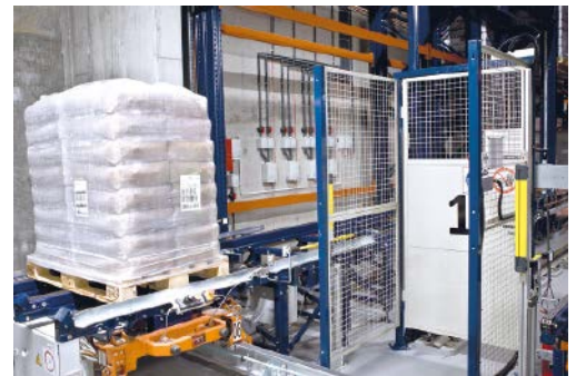
Auf Paletten gepackt, werden die Zuckerprodukte im 35 m hohen, automatisierten Hochregallager zum Weiterversand verstaub
