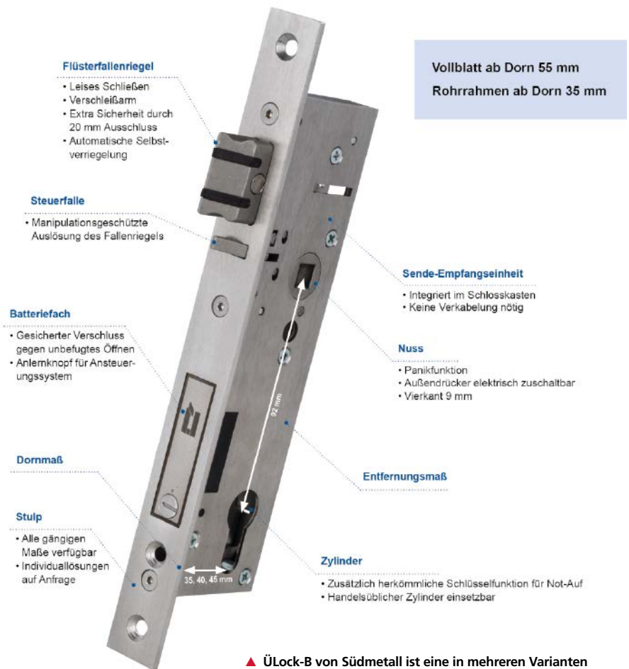
▲ ÜLock-B von Südmetall ist eine in mehreren Varianten erhältliche Produktgruppe von Schlössern mit Panikfunktion
