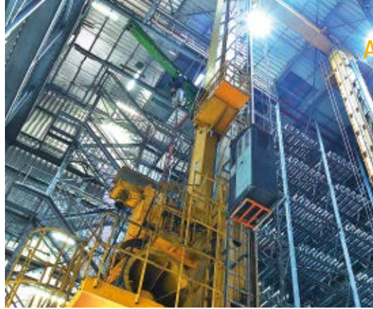
Service-Lifte im Anwendungsbeispiel eines Hochregallagers
