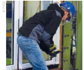
© FVSB Prüfung eines einbruchhemmenden Fensters im Prüfinstitut Schlösser und Beschläge Velbert (PIV)
