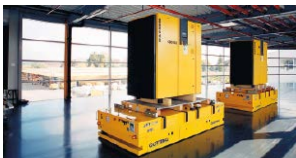
Mit und ohne Hindernis ermöglicht die Echoring-Technologie im FTS von Götting sicheren Transport
