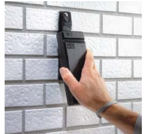
Kompaktes Lesegerät für magnetisch kodierte Kontrollstellen – das elektronische Wächterkontrollsystem WK1000 war das erste eigene Produkt von Deister Electronic
