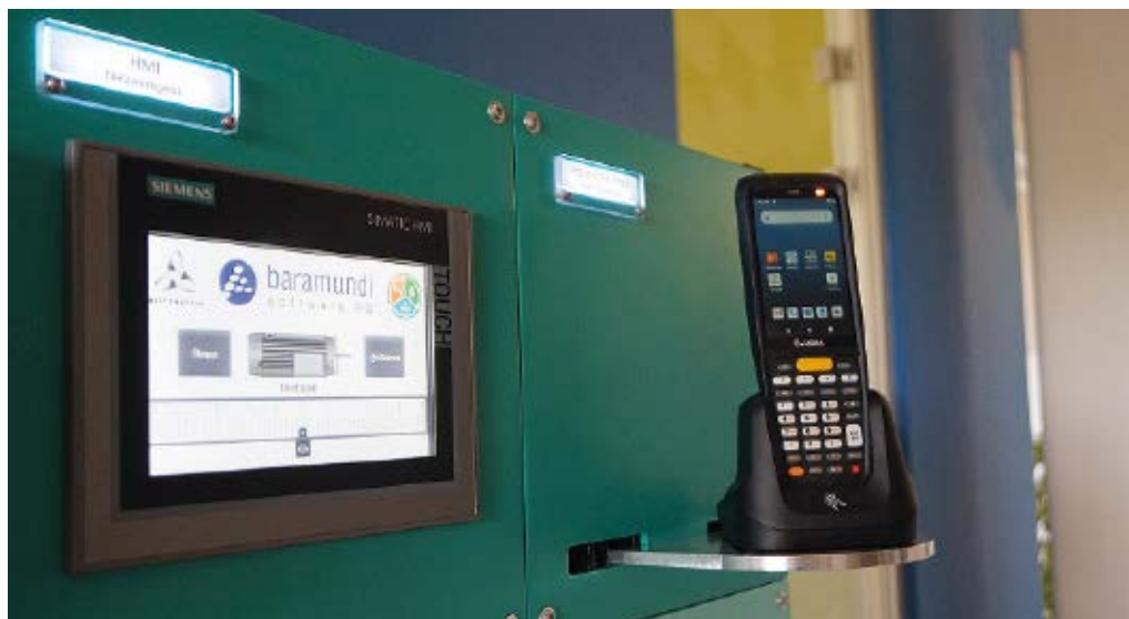
Der OT-Demonstrator von Baramundi und Fraunhofer ist modular aufgebautes Lehrwerkzeug, das anschaulich die verschiedenen Ebenen zeigt, auf denen die vernetzte Produktion nach dem Konzept der Industrie 4.0 basiert
