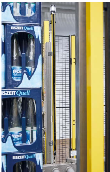
Durch den Einsatz der Sicherheits-Lichtvorhänge in der Ausführung mit SPG kann auf zusätzliche signalgebende Muting-Sensoren verzichtet werden
