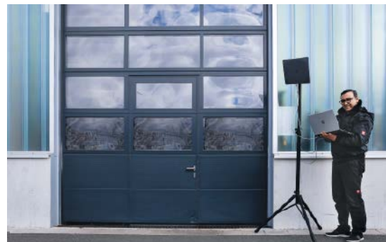
Eine Testinstallation ist sinnvoll, um die Position des Longrange-Lesers festzulegen
