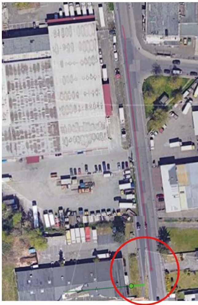
Target Historie (Fahrzeug angehalten) und aktives Target innerhalb bestimmten Radius und Zeitintervall löst Szenario-Alarm aus
