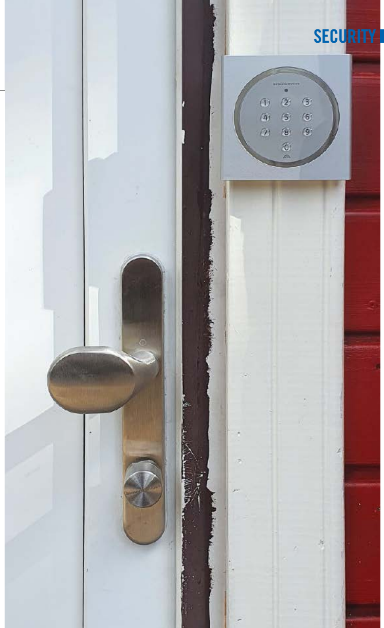
Schließsystem MobileKey von SimonsVoss: Die zweiteiligen Sets bestehen jeweils aus einem digitalen Schließzylinder und einer flachen Pincode-Tastatur
