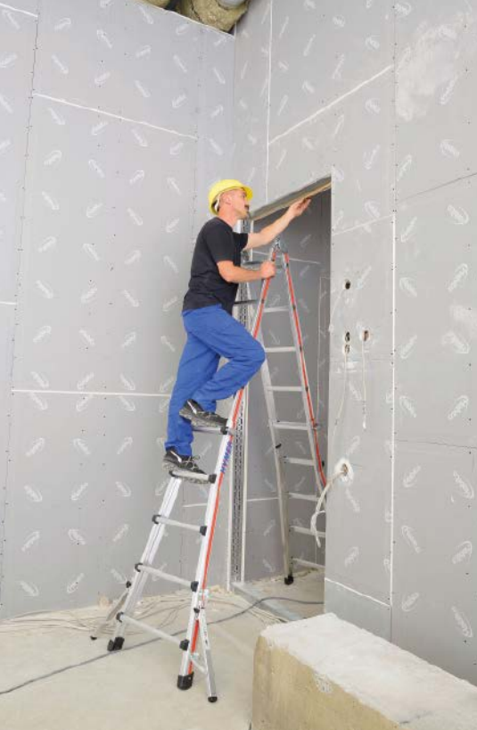
Seit Juni 2020 müssen gemäß der neuen Fassung der EN 131-4 auch die beliebten Teleskopleitern mit einer Standverbreiterung ausgestattet sein
