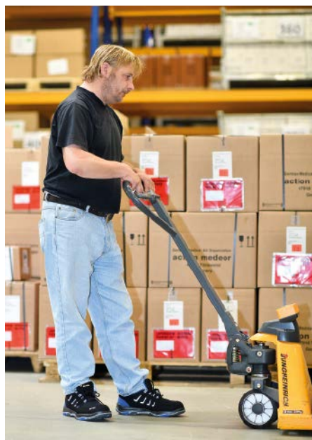
Ein unachtsames Hantieren mit dem Hubwagen kann schnell zu Quetschungen der Füße führen, daher sind Sicherheitsschuhe Pflicht
