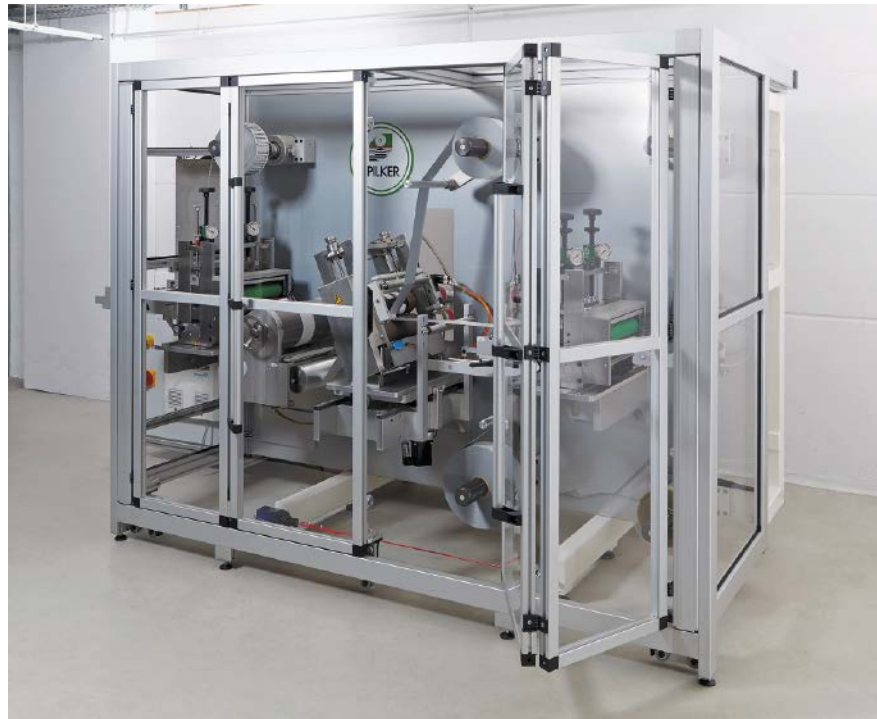
Flächenelemente aus Acrylglas oder Polycarbonat garantieren Sicherheit, Staubschutz und optimale Sicht auf die Maschine
