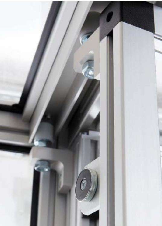
Ein Magnetkontakt (schwarzer Kreis) sichert die Falttüre in ihrer Position
