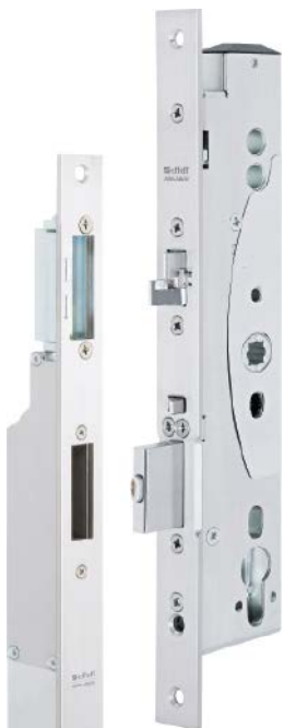
Selbstverriegelndes Fluchttürschloss Mediator von Assa Abloy: Durch die integrierte Panikfunktion lässt sich die Tür bei Gefahr und im Normalbetrieb jederzeit von innen ohne Schlüssel öffnen, obwohl sie von außen permanent geschlossen ist
