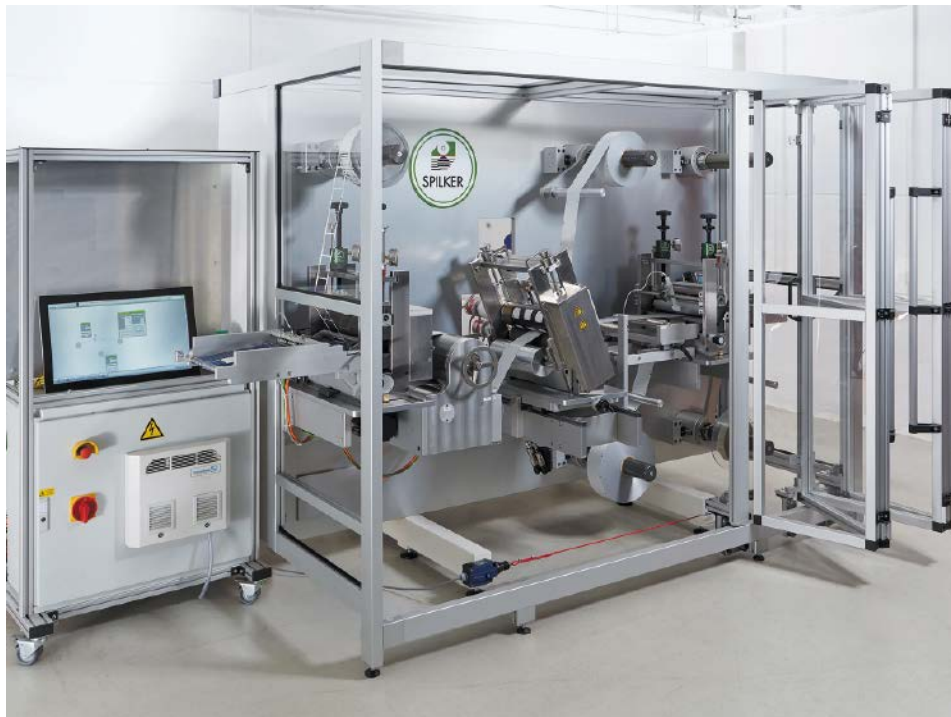
Die Falttüren der Schutzzeineinhausung sind an einem über eine Rollführung verschiebbaren Pfosten aus Aluminiumprofilen montiert
