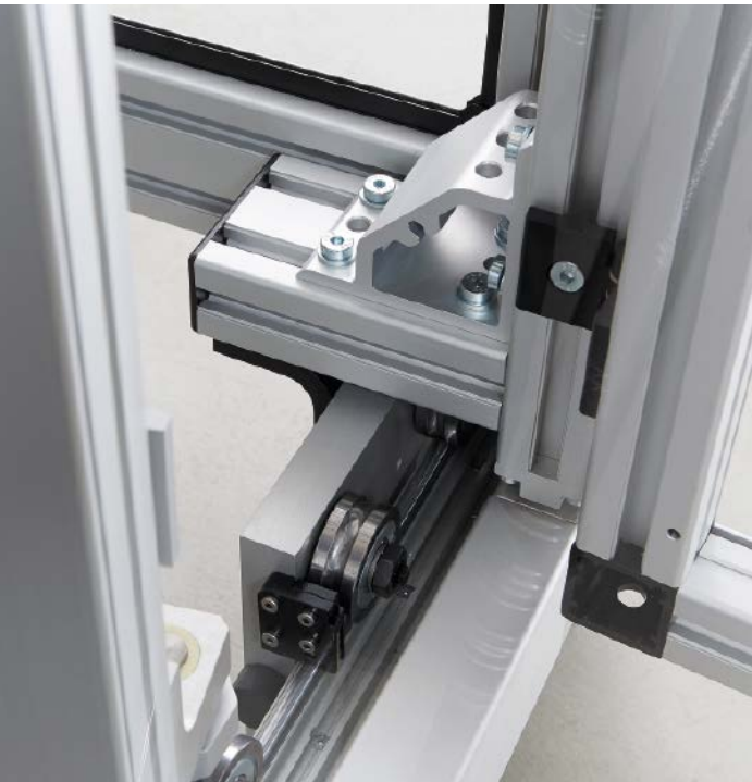
Der verschiebbare Profilpfosten wird über eine Rollführung bewegt
