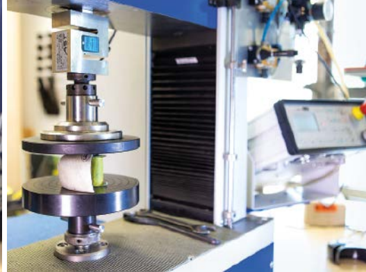
▲ Im Haix-eigenen Labor werden die Sicherheitsschuhe umfassend getestet – hier die Schutzkappen im Drucktest
