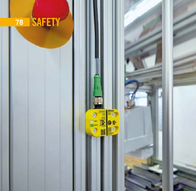
▲ Der berührungslose Sicherheitsschalter PSRswitch überwacht sicher den Zustand der trennenden Schutzeinrichtung, z. B. einer Klappe oder Tür, und bietet dabei maximalen Manipulationsschutz gemäß DIN EN ISO 14119
