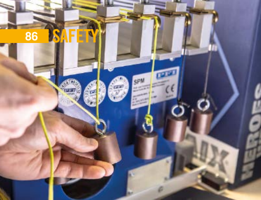
▲ Auch die Zugfestigkeit der Schnürsenkel wird gewissenhaft überprüft
