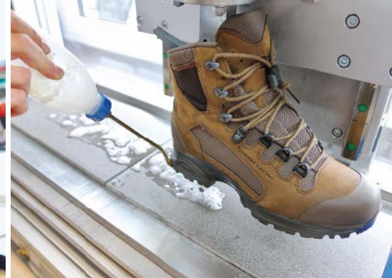
▲ Um die Rutschfestigkeit nach Standard SRA zu prüfen, wird der Schuh fünfmal maschinell über eine Normfliese geschoben, auf die ein Rutschmittel aufgetragen wurde
