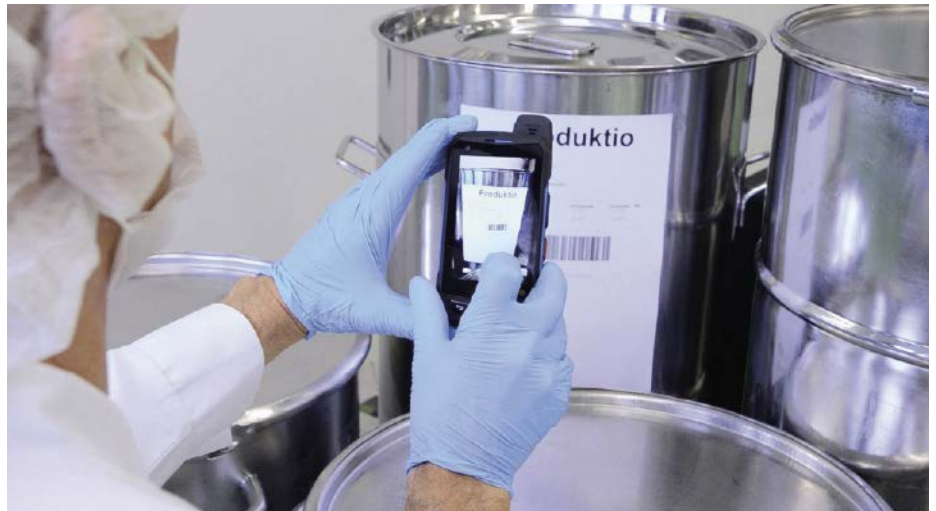
Verlässliche Identifikation von Gebinden mittels Barcodescanner über die Kamera des explosionsgeschützten Smartphones Smart-Ex
