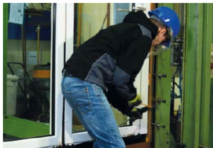
Prüfung eines einbruchhemmenden Fensters im Prüfinstitut Schlösser und Beschläge Velbert (PIV)
