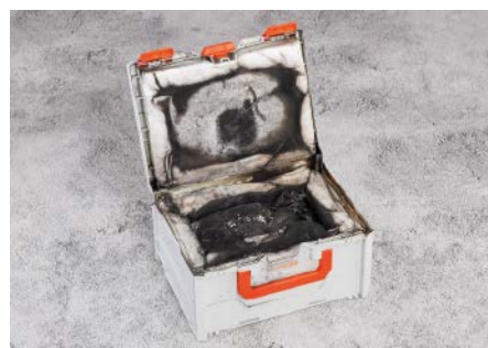
Nach Batteriebrandversuch: Die nicht brennbare Innenausstattung überzeugt im Ernstfall
