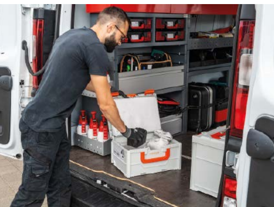
Die geprüfte Akku-Systembrandschutzbox ist im Servicefahrzeug schnell zur Hand: Bei einem defekten Akku (Gefahrgut) vorgeschrieben und auch für die ADR-Handwerkerregelung geeignet
