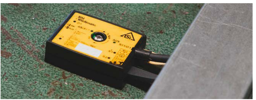
Aktiver Verteiler ASI Safety (BWU3565) in IP67 für die einfache, schnelle und sichere Integration eines Türschalters über das Profilkabel in das ASI Netzwerk.
