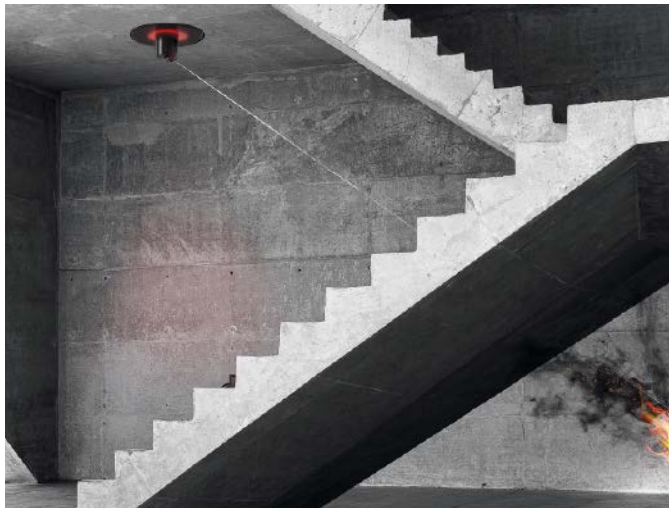
▲ Löschangriff im Rohbau: Ein durch künstliche Intelligenz (KI) gesteuerter Löschroboter bedeckt das Feuer mit einem gezielten Löschmittelstrahl
