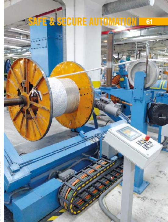
Der Aufwickler erhielt eine neue Schutzeinhausung mit Türzuhaltungen sowie Bedienpulte für manuelle Betätigung
