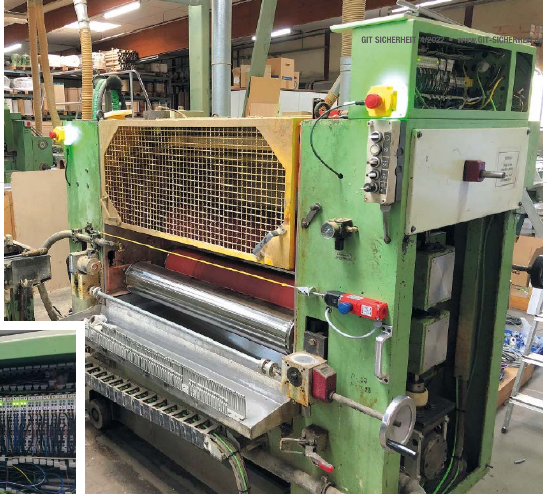
▲ Retrofit einer Kaschieranlage aus dem Jahre 1996: Unter anderem kommen darin nun Seilzugschalter und beleuchteten Not-Halt Geräte von Bernstein in einer elektronischen Sicherheitskette zum Einsatz
