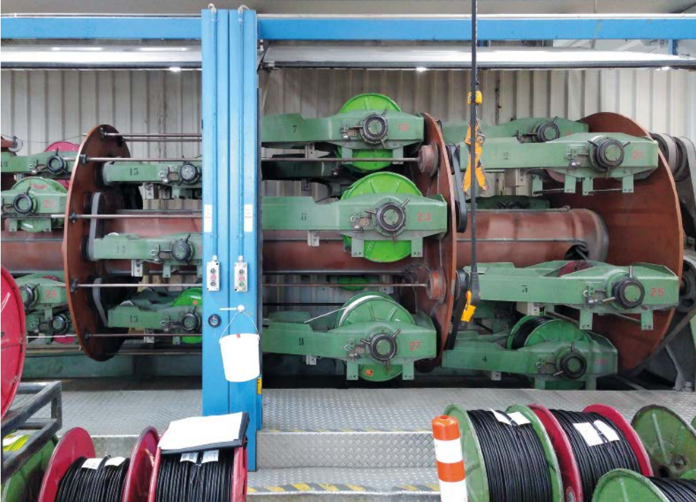
Der Korbverseiler dreht sich mit konstanter Geschwindigkeit um seine horizontale Achse. Rundum sind mehrere Trommeln auf Spulenträger aufgespannt
