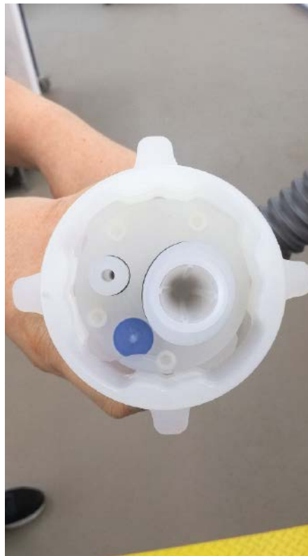
In der Kupplung des EcoMix Revolution befindet sich ein RFID-Schreib-Lesekopf des Typs RLS-1183-020, Ø 18mm
