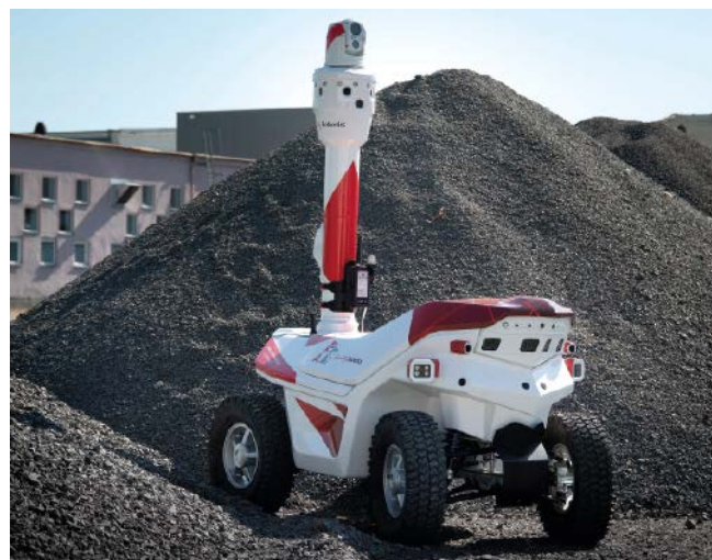
Überwacht auch große Gelände: radbetriebener Sicherheitsroboter „Argus“
