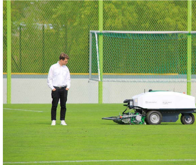
▲ Der in RoviMo eingebaute Sicherheits-Laserscanner für den Außenbereich outdoorScan3 von Sick schützt Personen und Tiere im Außenbereich und verhindert damit Kollisionen
