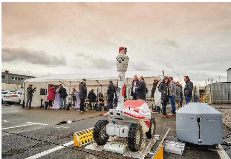
Patrouillenroboter mit vier Rädern: „Argus“ kann dank PTZ-Kamera mit thermischen und optischen Sensoren Personen und Objekte bis zu 100 Meter erkennen
