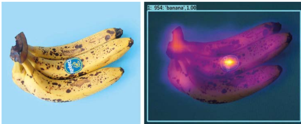
Die Heatmap visualisiert eine hohe Aufmerksamkeit bei dem Chiquita-Label der Banane und ist damit ein gutes Beispiel für einen Daten-Bias: Durch falsche oder zu wenig repräsentative Trainingsbilder von Bananen hat das verwendete Convolutional Neural Network (CNN) gelernt, dass dieses Label auf eine Banane schließen lässt
