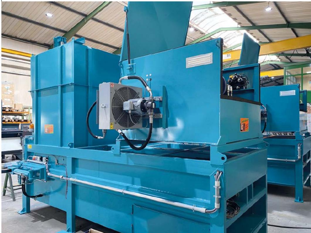
Die Verdichtungsanlage von Ludden & Mennekes wird dort eingesetzt, wo größere Mengen an Reststoffen und wiederverwertbaren Rohstoffen vor dem Transport verdichtet werden sollen. Die Sicherheitstechnik der Anlage setzte Bernstein um
