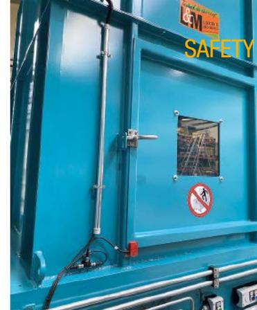
Die berührungslosen Sicherheitssensoren SRF von Bernstein überprüfen, ob die Wartungskappen ordnungsgemäß verschlossen sind. Stellt der SRF fest, dass dies nicht der Fall ist, wird die Anlage sofort außer Betrieb genommen
