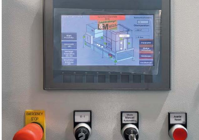
Alles auf einen Blick: Alle für den Betrieb relevanten Informationen über die Anlage erhält der Bediener übersichtlich auf einem Display. Hier ist auch schnell erkennbar, welcher Sicherheitssensor SRF eine Störung meldet
