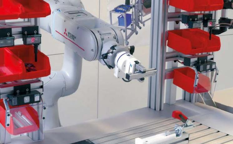
Kollaborative Roboter können den Werker am Montagearbeitsplatz entlasten, indem sie ihm Material zuführen, bei einzelnen Montageschritten Teile halten oder die Ablage der fertigen Bauteile übernehmen
