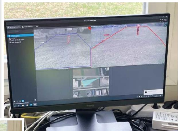
wendung Axis Object Analytics ist in der Firmware der Kamera vorinstalliert und sorgt ebenfalls für eine KI-basierte Objektanalyse in der Szene. Damit lassen sich beispielsweise Personen, Fahrzeuge und Fahrzeugtypen erfassen und klassifizieren.
