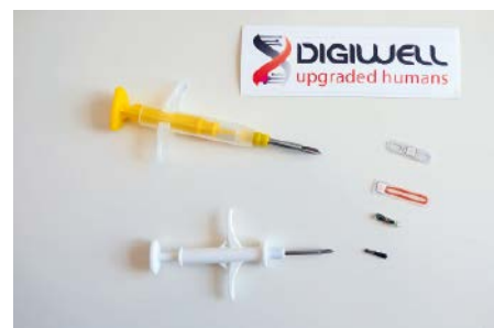
Die kleinen x-Series Tags werden mit einer Kanüle direkt unter die Haut gesetzt. Die flachen Flex-Implantate hingegen sollte ein erfahrener Body-Modder oder Arzt einsetzen
