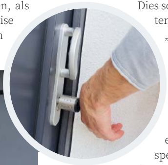
▲ Nur kurz die Hand vor den Knauf halten, schon leuchtet der elektronische Wilka-Zylinder grün auf und die Tür ist entriegelt
