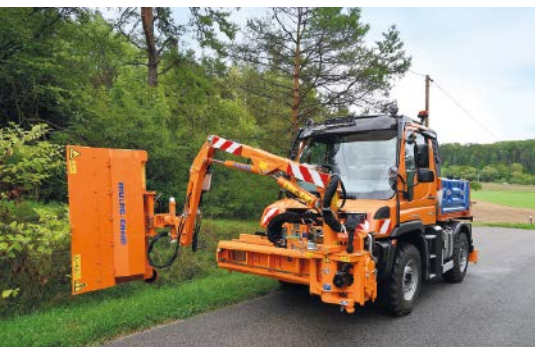
Berühmter Vielseiter: Der Unimog – hier als U219 mit Sommer- und Winterdienstkombination
