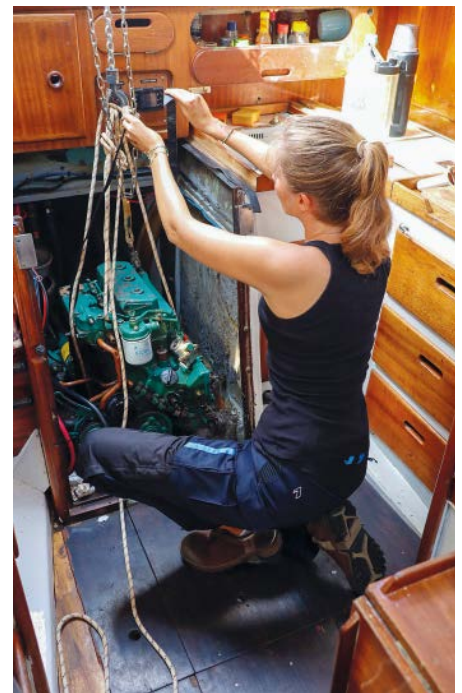
Hannah beim Ein- und Ausbau des Motors in beengten Verhältnissen. Sicherheitsschuhe und Arbeitsschutzhose sind hier ein Muss
