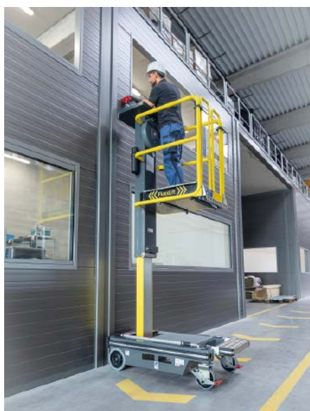
Mit dem FlexxLift befindet sich der Anwender bei Installations-, Wartungs- oder auch Reparaturarbeiten im rundum gesicherten Arbeitsbereich
