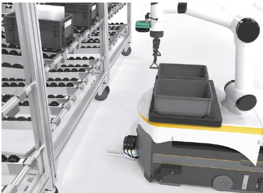
Sichere Positionierung an geschlossener Code-Schiene des safePGV-Systems
