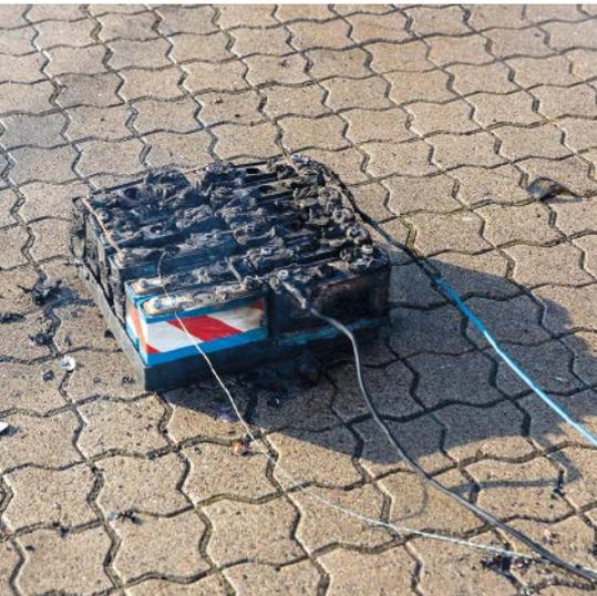
Brandversuch mit Lithium-Ionen Batteriemodul zeigt den Effekt des Thermal Runaways und der Propagation
