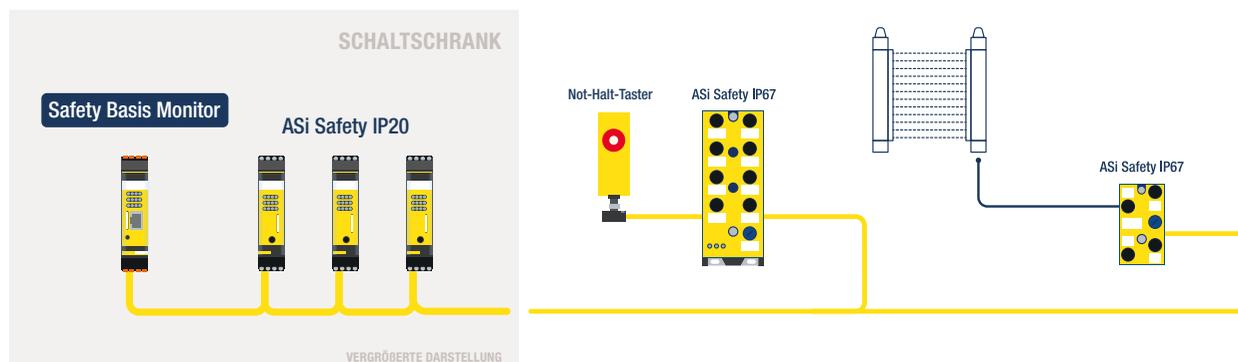
Der Safety Basis Monitor als sichere Kleinsteuerung lässt sich in größeren Applikationen einfach um sichere und nicht-sichere ASI Module erweitern.
