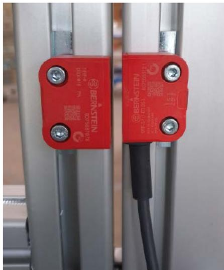
Der berührunglose Sicherheitssensor SRF überwacht beweglich trennende Schutzeinrichtungen wie Türen, Klappen oder Hauben
