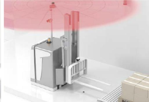
LiDAR-Sensor R2000 für Navigation mit Rundumsicht
