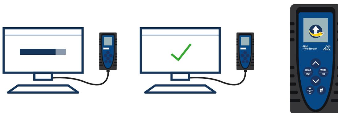
Neue Funktionalitäten für das ASI-5/ASI-3 Handadressiergerät können per Firmware-Update heruntergeladen werden. Dazu wird das Gerät über die USB-C Schnittstelle mit der PC-Software ASIMON360 verbunden.
