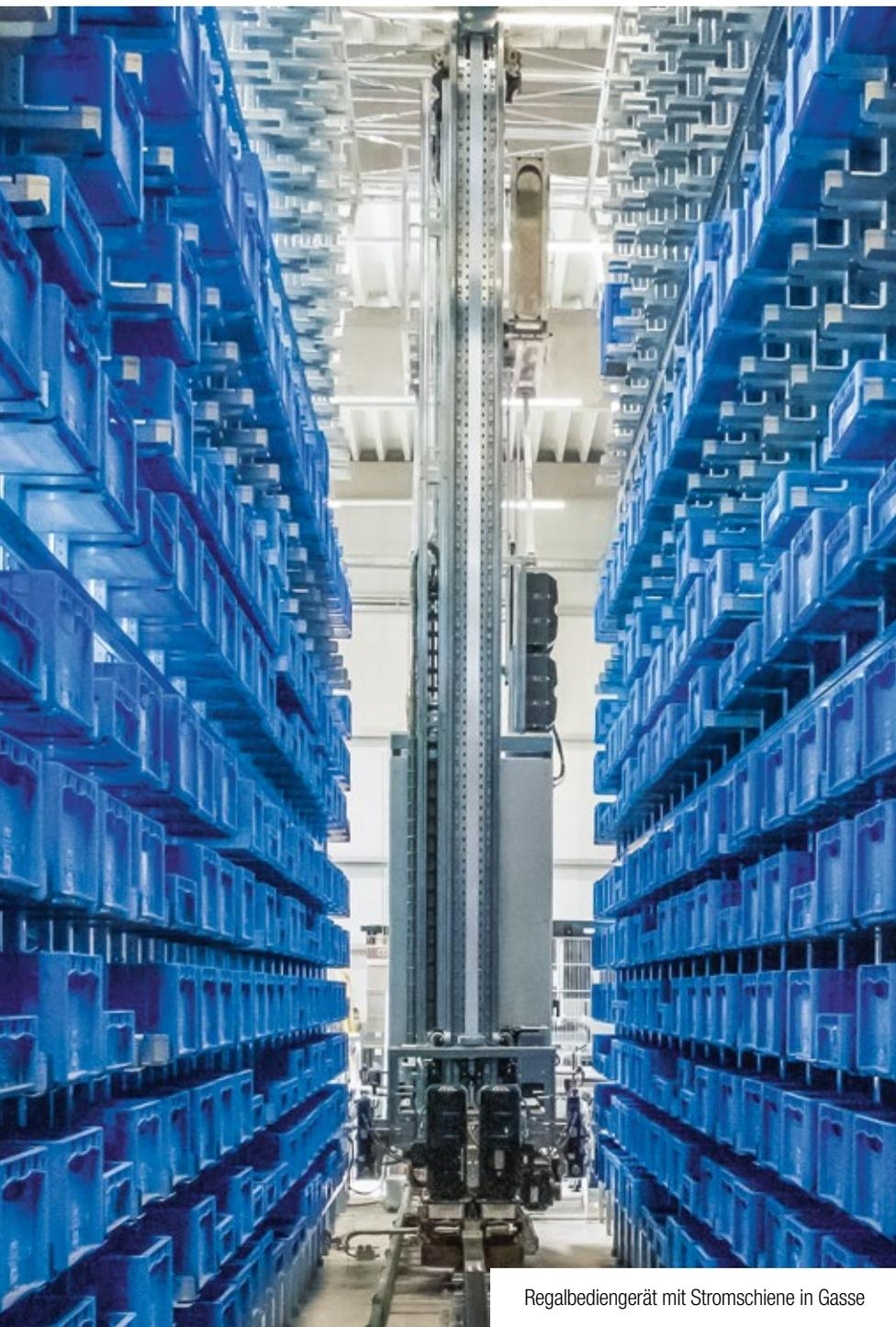
Regalbediengerät mit Stromschiene in Gasse
