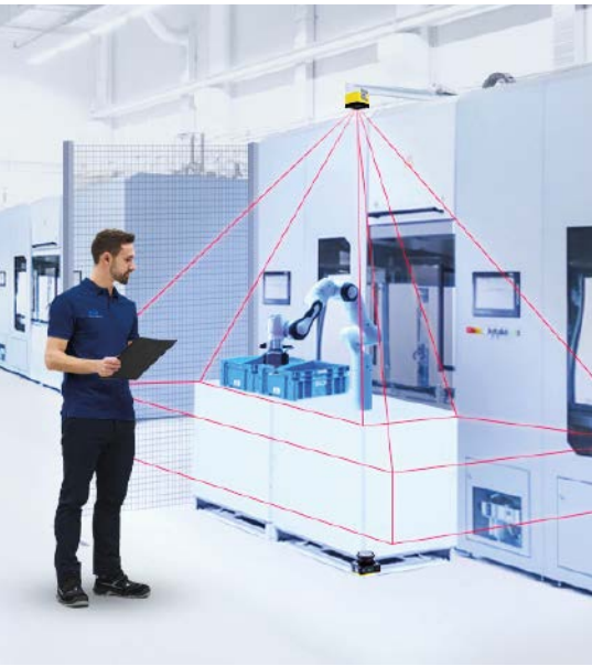
safeVisionary2 erfasst in Anwendungen mit Mensch-Roboter-Interaktion sicher Restrisiken wie das Überbeugen oder Übergreifen von Personen
