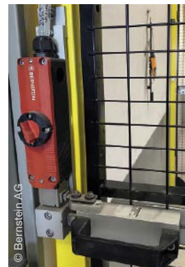
Die Zuhaltung „SLC“ verwehrt den Zugang zum jeweiligen Lackierroboter
