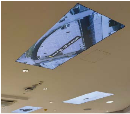
Monitore eignen sich auch für komplexe Signage-Applikationen – wie hier: eingelassen in eine abgehängte Decke
