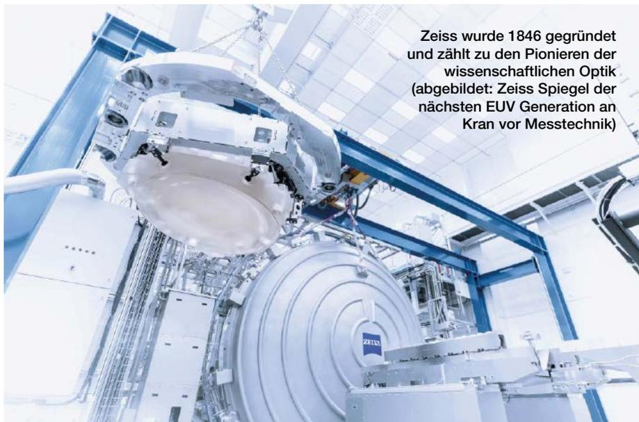
**Zeiss wurde 1846 gegründet und zählt zu den Pionieren der wissenschaftlichen Optik (abgebildet: Zeiss Spiegel der nächsten EUV Generation an Kran vor Messtechnik)**
