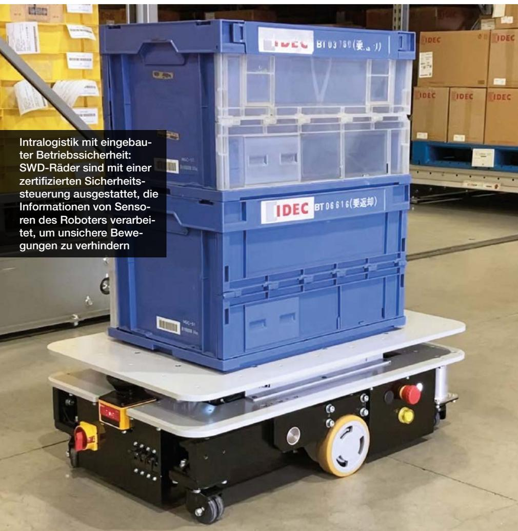
Intralogistik mit eingebauter Betriebssicherheit: SWD-Räder sind mit einer zertifizierten Sicherheitssteuerung ausgestattet, die Informationen von Sensoren des Roboters verarbeitet, um unsichere Bewegungen zu verhindern
