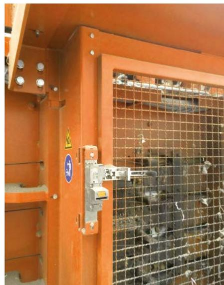
**Mechanische und verdrahtungslose Absicherung von trennenden Schutzeinrichtungen**
