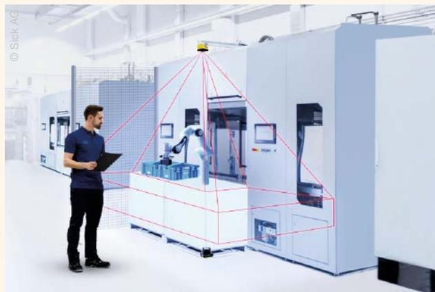
Beispiel für den Einsatz einer Safety Kamera (VBPD) zur Absicherung eines kollaborierenden Roboters
