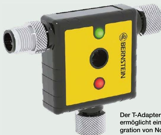
Der T-Adapter von Bernstein ermöglicht eine effiziente Integration von Not-Halt-Geräten, indem er zwei elektromechanische Öffnerkontakte überwacht und die Informationen über das DCD-System weiterleitet
