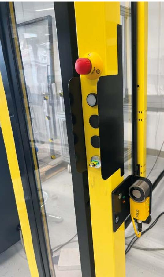
Das Zugangsberechtigungssystem PITreader entscheidet anhand der auf dem Schlüssel gespeicherten Berechtigungen, wer Zugang zur Anwendung erhält. Die elektromagnetische Sicherheitszuhaltung PSENSlock (rechts) sorgt für die sichere Türzuhaltung
