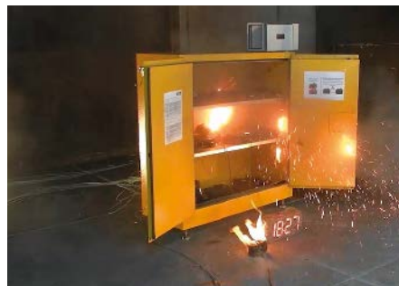
Explosionsversuch mit Akkuschränken – Ausschnitt aus dem Cemo-Produktvideo. Bild links: Türen des F-Safe Schrankes werden durch den Druck aufgesprengt, Bild rechts: Der Cemo Akku-Schrank (Li-Safe) mit lockEX-Verschlussmechanik hält stand.
