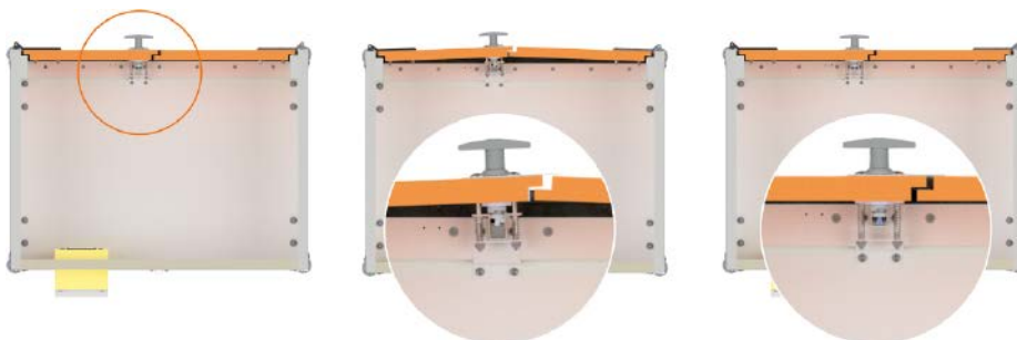
Die lockEX-Verschlussmechanik baut die Explosionsenergie durch einen schmalen Spalt kontrolliert ab
