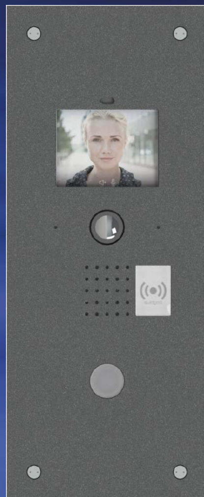
IP-Video-Türsprechstelle mit Zusatzfunktionen: multiple Telefonanlage, Direct-SIP-Call und Smartphone-Anruf, 8MP-Hemisphären-Kamera, 3-Faktor-Authentifizierung
