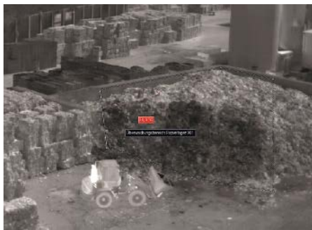
Thermografiebasierte Kameras stellen die Oberflächentemperaturen der überwachten Objekte in einem Wärmebild über den gesamten Erfassungsbereich dar
