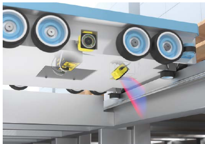
Anwendung in Lagerfördertechnik: Sichere Positionierung auf zwei Achsen in Shuttle Systemen mit dem SafePXV/PUS System. Das SafePXV-System verwendet mehrfache Redundanz: mehrfarbige Codes, Sensor mit Kamera und zweifarbigem LED-Ring zur sicheren Positionierung mit nur einem Lesekopf
