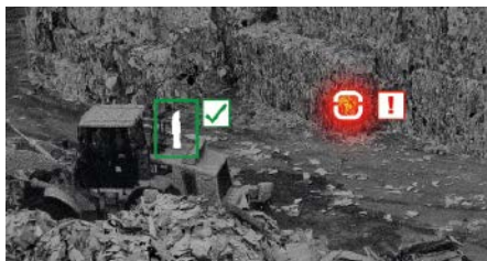
Intelligente Algorithmen erlauben auch in der thermografiebasierte Branddetektion die zuverlässige Erkennung von Störgrößen und Falschalarmen
