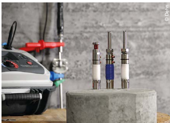
HVI check für die einfache Funktions- und Zustandsbestimmung der HVI-Leitungen
