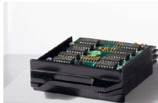
Interflex entwickelte einen damals fälschungssicheren und patentierten Infrarotkartenleser, den das Unternehmen ab 1977 in allen Zeiterfassungs- und Zutrittslösungen verbaute
