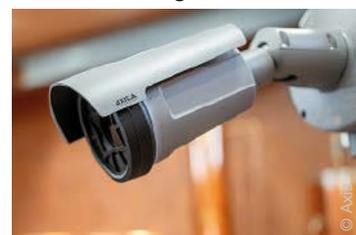
Die Q1961-XTE fungiert als Wärmebildkamera, die neben der Visualisierung des Infrarot-Wärmebilds auch die Temperaturentwicklung aus größeren Entfernungen punktgenau überwachen kann
