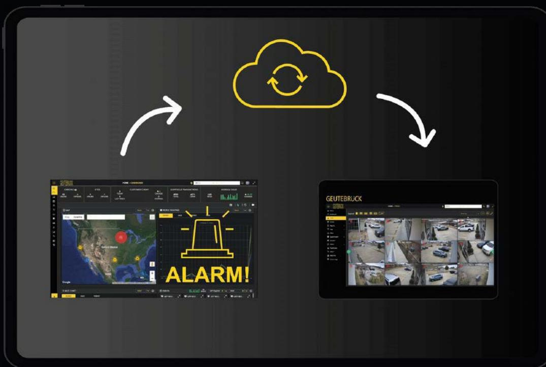
**G-Lives:** Bei Alarm schickt der cloud-gehostete Service einen Web-Link für den temporären Zugriff auf Live- und Alarmbilder des on-premise Systems. Einsatzkräfte können so gezielt reagieren
