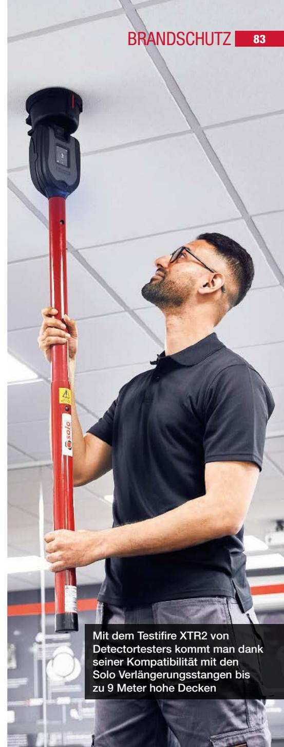
Mit dem Testifire XTR2 von Detectortesters kommt man dank seiner Kompatibilität mit den Solo Verlängerungsstangen bis zu 9 Meter hohe Decken
