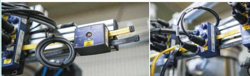
ASi-5 Modul BWU4088 mit einem IO-Link Master Port (links) und BWU4067 mit vier IO-Link Master Ports (rechts).
