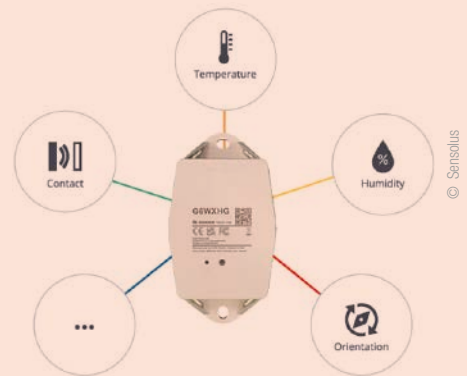
Tracker von Sensolus empfangen per Datenübertragung von den Sensoren Informationen über Temperaturen, Feuchtigkeit, Zustände von Tür und Tor und weitere Navigationsdaten.
