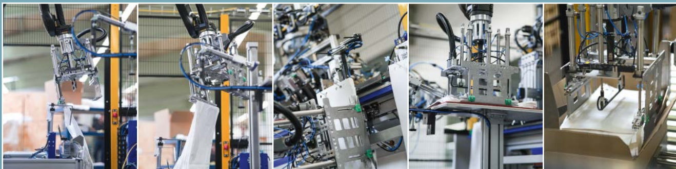
Transport eines Beutelstapels vom Ablageort über das Anbringen von Pappe und Stopfen sowie das Verschuppen des Bügels bis zur Ablage in den Karton.
