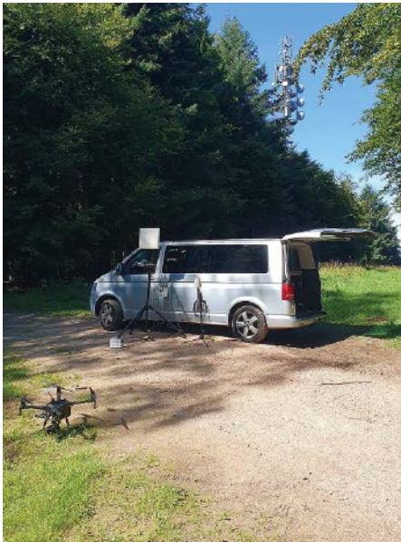
Drohne vom Typ DJI Matrice M210 im Vordergrund und Passivradar-Lösung vor dem PKW. Im Hintergrund ein LTE450-Sendemast
