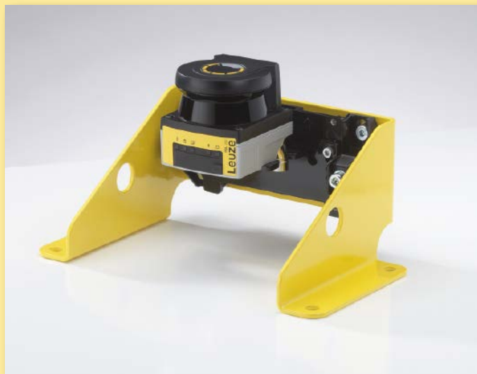
Mit der eigens für den RSL 200 entwickelten Halterung lässt sich der Sicherheits-Laserscanner horizontal und vertikal ausrichten, im Servicefall kann er mit nur vier Schrauben schnell ausgetauscht werden
