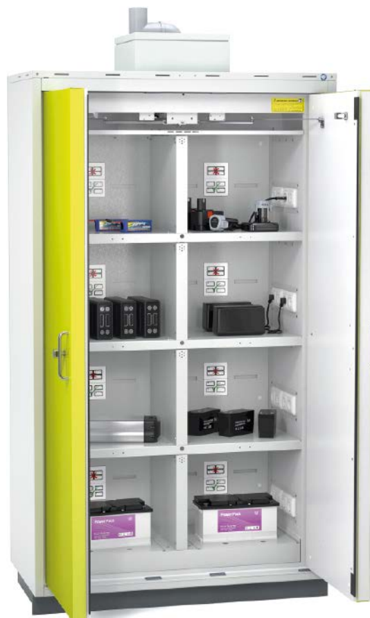
Thermisch isolierte Lagerböden mindern das Risiko, dass Brände innerhalb der Lagerebenen überspringen
