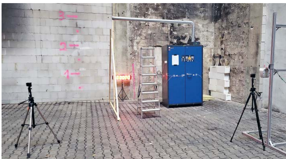
Prüfaufbau „thermal runaway“ gemäß VDMA-Einheitsblatt 24994
