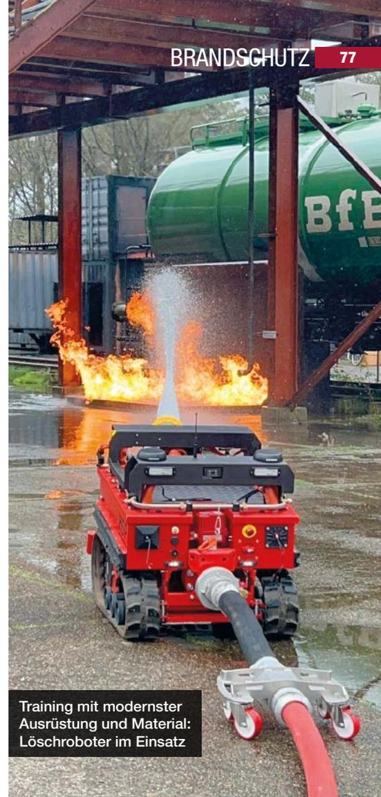
Training mit modernster Ausrüstung und Material: Löschroboter im Einsatz
