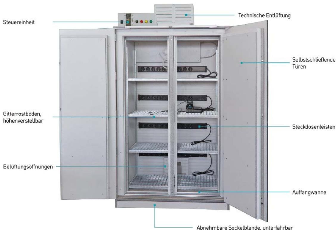
Offene Böden ermöglichen im Brandfall eine optimale Wirkung der Löscheinheit und verbessern die Abführung der Wärme während des Ladevorgangs
