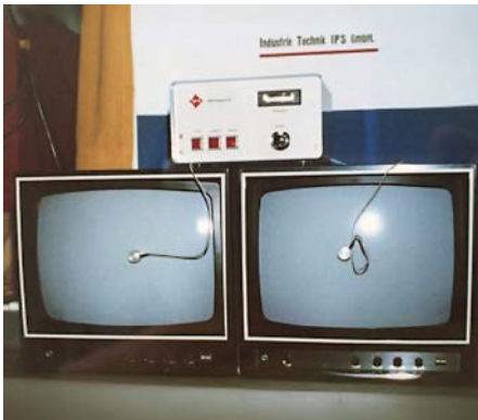
Der Deltaguard im Jahr 1970: Das System arbeitete mit einer auf den Bildschirm aufgeklebten Fotodiode, die Helligkeitsveränderungen im Videobild erkennen konnte.
