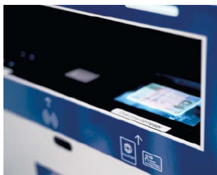
Ein integrierter Dokumentenscanner ermöglicht eine zuverlässige Überprüfung von Ausweisdokumenten (ID-Check)
