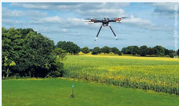
Drohnen hören, bevor man sie sieht: Die Lösung des Fraunhofer IDMT detektiert und lokalisiert Drohnen auch außerhalb des Sichtfeldes mittels intelligenter akustischer Sensorik
