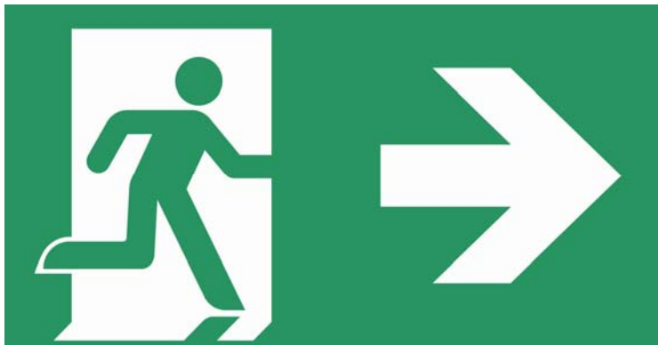
Beispiel für Rettungsweg/Notausgang (E002) mit Zusatzzeichen (Richtungspfeil)
