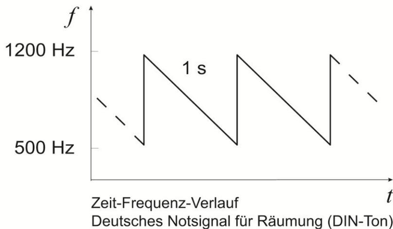
Abbildung 1: Zeit-Frequenz-Verlauf "Deutsches Notsignal für Räumung" (DIN-Ton)
