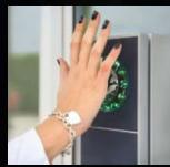
tiert der Sabotage-Kontakt. Für höchste Sicherheit bei der Erkennung sorgt die Mehrfaktor-Authentifizierung. Die neue Version erkennt auch Personen mit zittrigen Händen und arbeitet bei 80.000 Lux. Die Innovation liegt in der Kombination der hochsensiblen Sensortechnik, die hochsichere Zutrittskontrolle für besonders schützenswerte Räume ermöglicht, mit der einfachen Anwendung, die dem Nutzer einen hohen Anwendungskomfort bietet.
