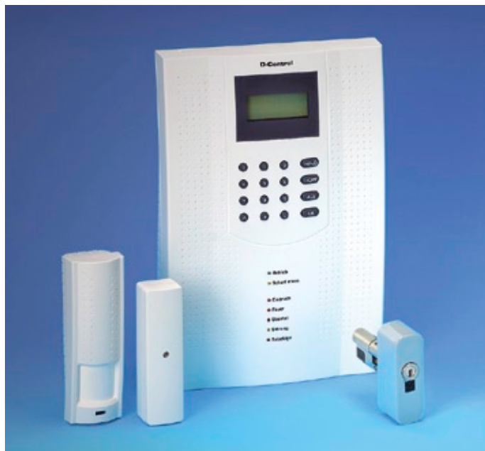
Daitem D-Control mit VdS Klasse H-Zulassung. Für private oder kleingewerbliche Objekte. Alle Melder arbeiten drahtlos. Rechts im Bild: Die Funk-Rosette, eine innovative Lösung zum zwangsläufigen Scharf-/Unscharfschalten per Funk, einsetzbar in Funk- und Draht-EMA.
